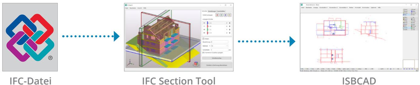
Das IFC Section Tool visualisiert das geometrische Gesamtmodell im vollen Detailgrad. Der praxisgerechte Ansichtsfiler erlaubt die Selektion von IFC-Objekttypen wie Wand, Stütze usw., um die Anzeige auf die benötigten Informationen abzustimmen. Anschließend können Schnittebenen und -tiefen definiert werden. Die optionale Schnittvorschau erlaubt die unmittelbare visuelle
